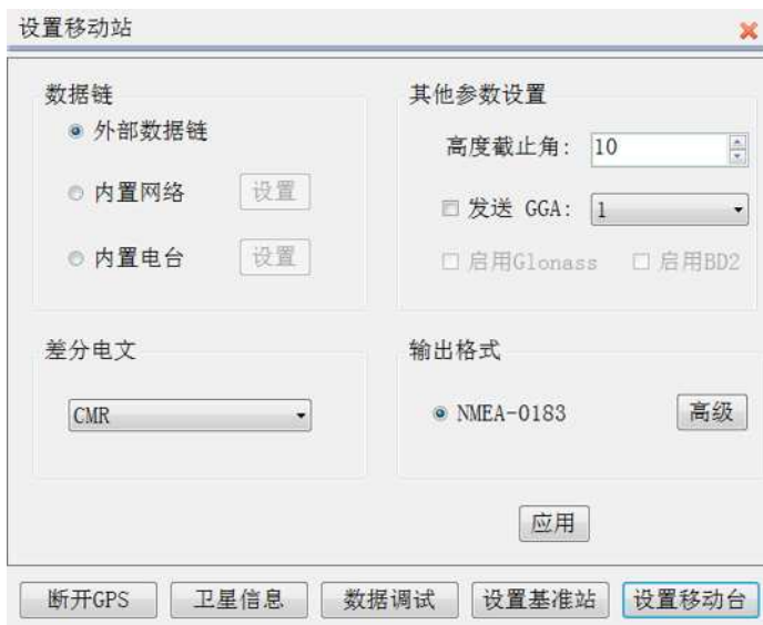
图 18-17 RTK 移动站设置
