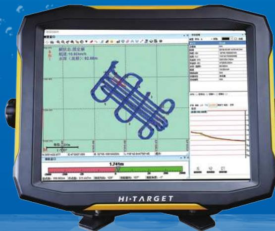
HD-LITE全数字化测深仪，融合了数字测深系统和计算机技术于一体。基于Windows7系统，内置全新HiMAX测深仪软件，集测深、导航、数据采集、后处理于一体，智能动态信号检测、识别和锁定跟踪，实时监测和控制测深全过程，保证了测深系统的高精度和可靠性。测深数据和图像可实时显示、存储、回放和打印。HD-LITE单波束测深仪是目前最先进可靠的全数字测深系统，广泛应用于水文勘察、航道码头、疏浚等行业的水深测量工程。
