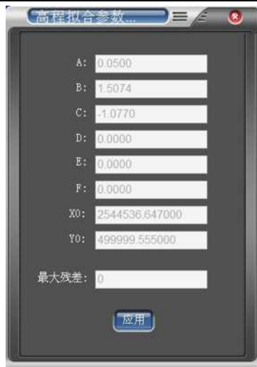
图 19-9 计算高程拟合参数
