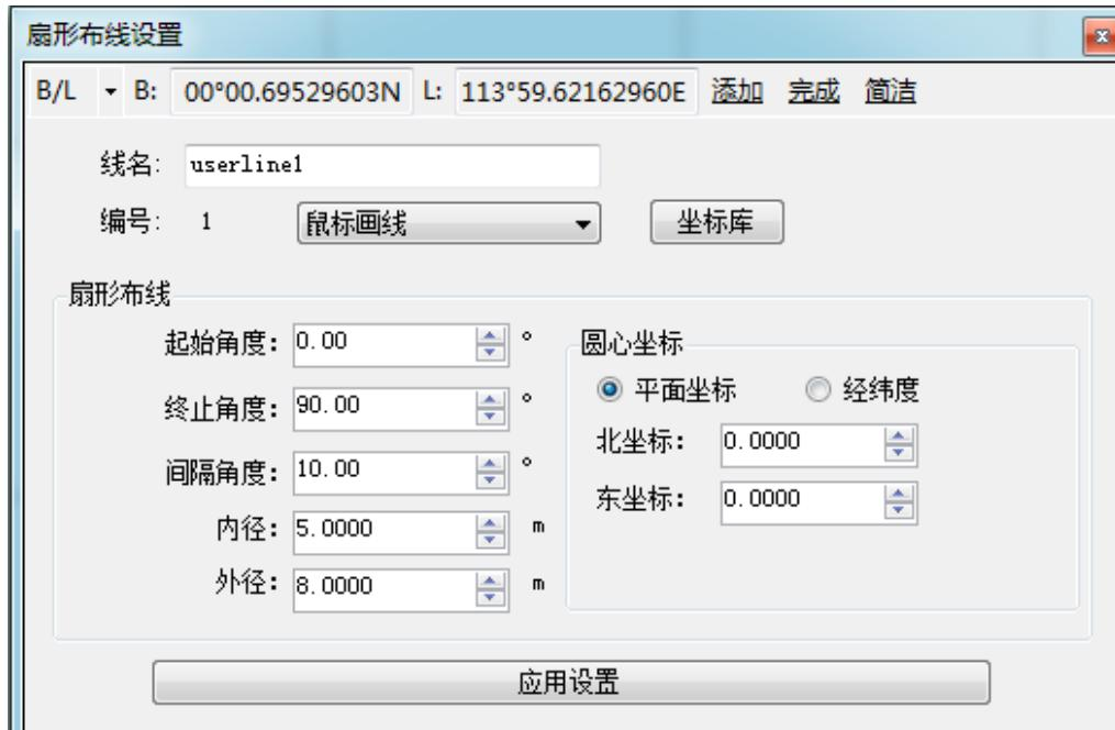
图 7-27 扇形计划线块编辑界面
