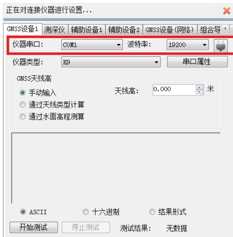
图 5-1 GNSS 串口设置
