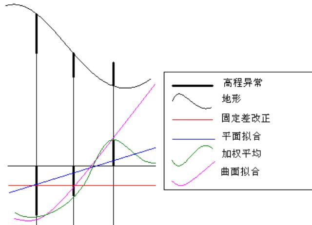
图 4-12 高程拟合平面模拟对比图
