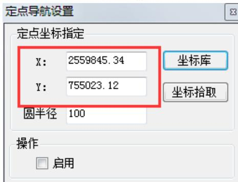
图 10-21 通过编辑框直接添加导航坐标平面坐标
