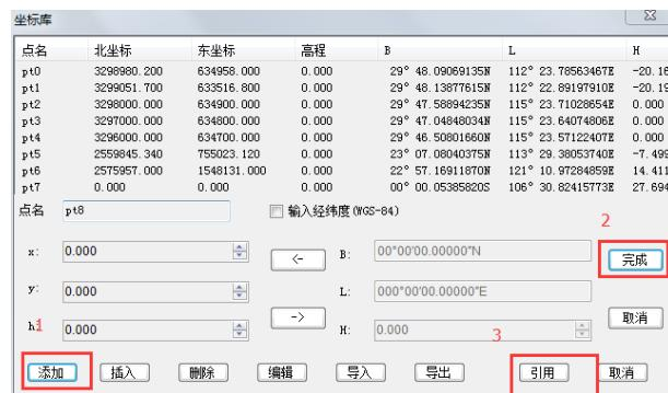
图 10-22 通过编辑框直接添加导航坐标平面坐标
