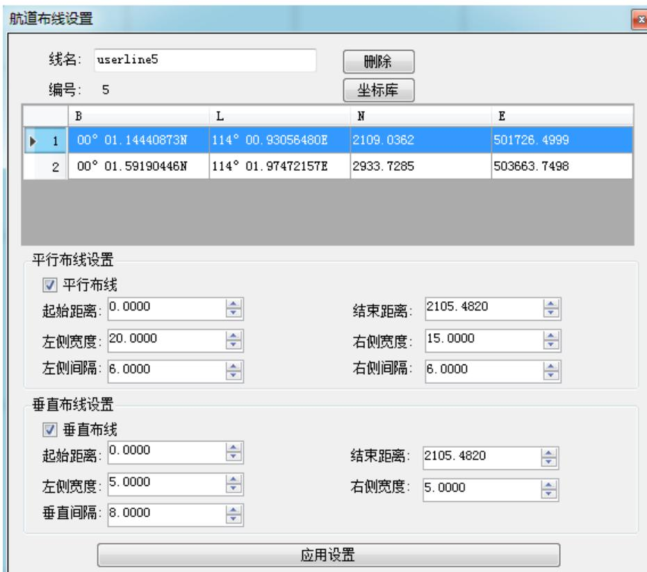
图 7-25 航道计划线编辑界面
