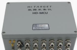
HD-MCU是一款中海达自主研发的多功能智能监测数据采集仪,产品提供模拟量、开关量、振弦、RS-232、RS-485、USB、RJ-45等丰富的物理接口,可自动采集并存储多种传感器的实时数据,利用现场采集的数据进行边缘计算和深度学习分析预测报警,报警联动控制。产品主要用于水库大坝、桥梁、公路边坡、地质滑坡以及尾矿库等场景。
