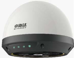
MS401接收机是一款小型化、低功耗、高性能、高稳定性的一体式GNSS接收机。内置高性能定位板卡、天线、MEMS传感器以及多种通讯模块,支持MEMS触发动静态结合解算、远程控制、APP配置、智能通讯切换等重要功能。该产品可广泛用于水库大坝、桥梁、公路边坡、尾矿库坝等应用场景的位移监测。
