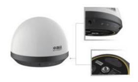
MS11接收机是一款低功耗、高性能、高稳定性的小型化一体式GNSS接收机。接收机内置全频段复合天线、高性能定位模块、MEMS传感器及多种通讯模块; 搭载高效智能物联网操作系统; 支持MEMS空间位置变化感知触发加密解算、4G远程控制、手机蓝牙APP配置、智能通讯切换及自我诊断等重要功能。 接收机结构上采用简易小型一体化设计,良好视觉感官效果,具备IP68防护等级,安装简单、防护可靠。适用于国土地灾矿山、边坡等监测领域。
