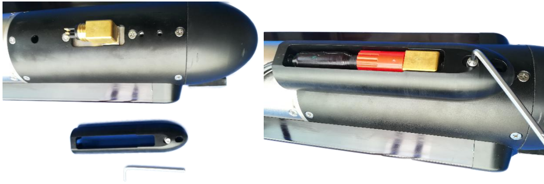
图 2.2 拖曳缆接口安装图示
