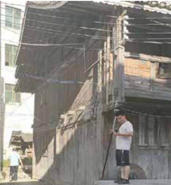
▲外业人员使用中海达 iRTK4 进行测量
