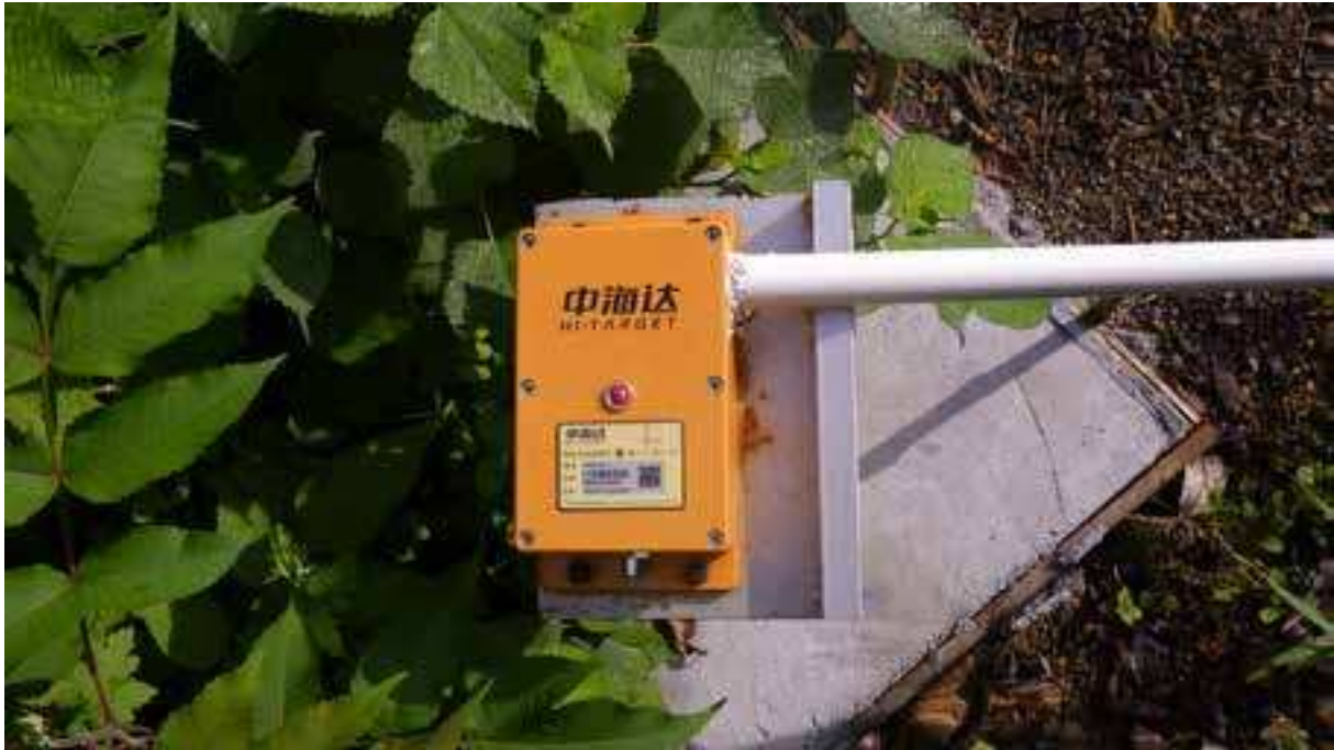
▲安装在辰溪县修溪镇移民学校内的中海达 HDS102 多维监测仪
