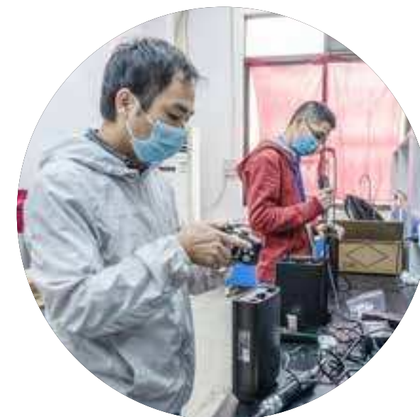
▲中海达技术人员对VNet8进行防水测试
