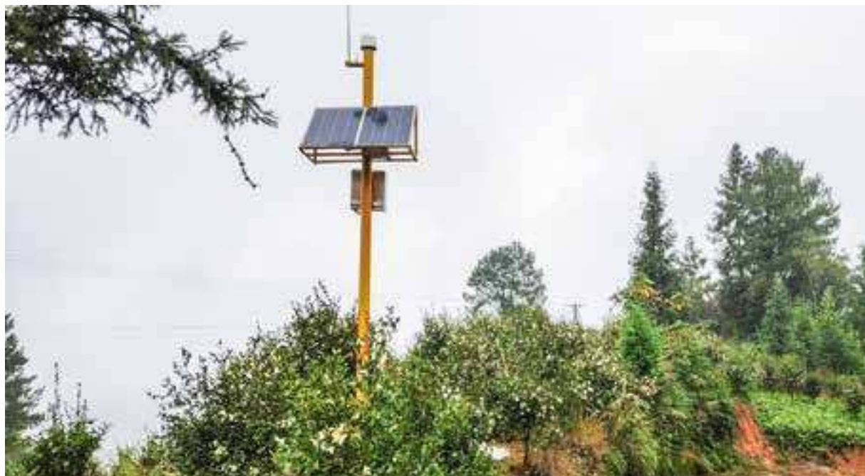
▲安装在重庆市灾害隐患点的中海达地质灾害监测设备
